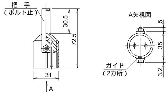
プラグ塗装色が黄色なので標準品(オレンジ)との識別ができます。ガイドを設け嵌合位置を特定しておりますので、SPT - 22 - G との併用により 2 回路のうち 1 回路だけを通电させる等の使用が可能です。
